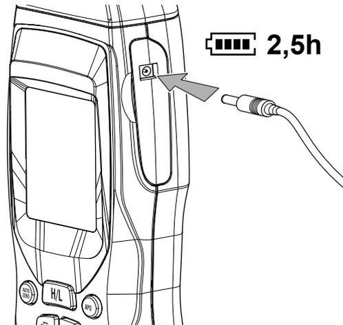
⇒ Cuando el aparato está encendido, en la pantalla aparece el indicador de carga.
